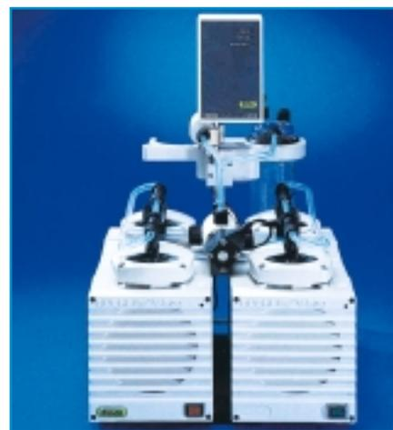
*Il sistema Vac V-1000 composto da due pompe raccordate per ottenere un vuoto fino a 1 mbar o potenza di aspirazione di 40 l/min*
