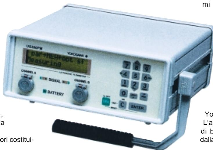
Il trasmettitore di portata a ultrasuoni portatile US300 PM
