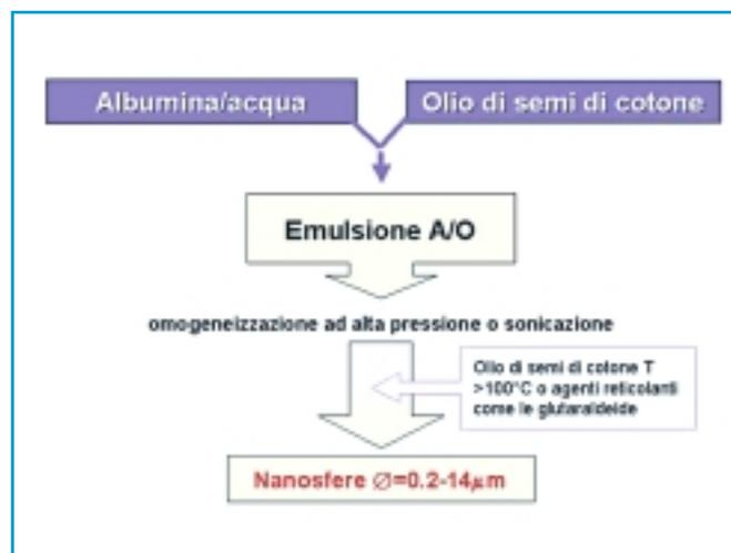
Figura 5 - Preparazione di nanosfere polimeriche mediante denaturazione termica
