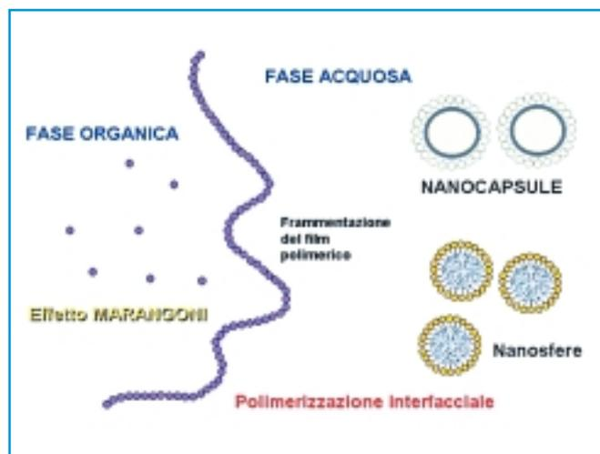
Figura 3 - Meccanismo di formazione di nanocapsule mediante polimerizzazione interfacciale
