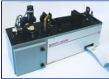
Figura 3 - Foto dello scanner a fluorescenza laser indotta progettato dagli autori e realizzato da Quanta Systems. Sulla sinistra si notano i due motori galvanometrici che orientano gli specchi di deflessione del raggio laser sulla lente piana sottostante
