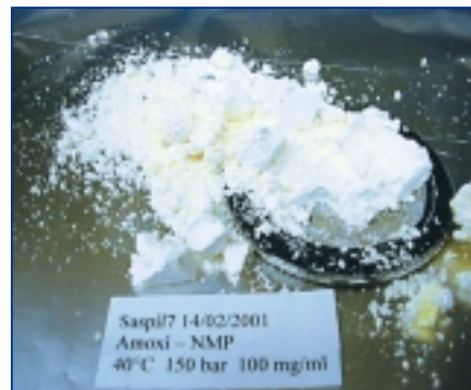
Figura 5 - Amoxicillina precipitata nell'impianto pilota. Condizioni operative: 150 bar, 40 °C, 100 mg/ml NMP
