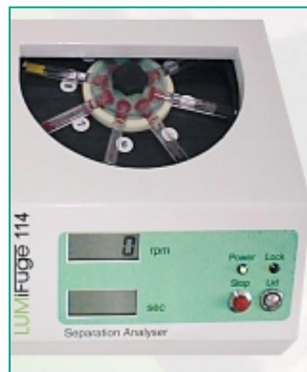
test effettuati sotto la sola forza di gravità. Il sistema analizza fino a 8 campioni contemporaneamente.
