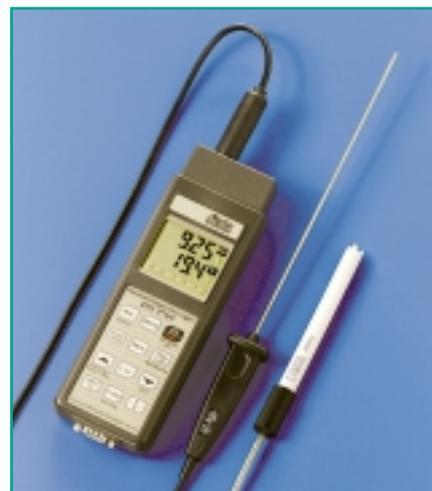
Lo strumento permette di eseguire la misura della concentrazione in mg/l e visualizzare l'indice di saturazione espresso in %, viene fornito con sonda di misura combinata di tipo polarografico a due o tre elettrodi (con membrane di ricambio o senza manutenzione) con sensore di temperatura interno. Il sensore di temperatura presente nella sonda e il sensore di pressione atmo-
