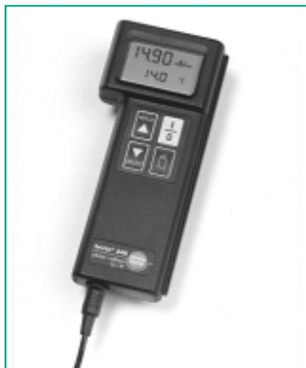
sura ed indicazione istantanea della conducibilità e della temperatura (campi di misura: 0- 2.000 mS/cm e -50 +150 °C), misura della temperatura con sonda da laboratorio ad immersione e per aria ambiente, scelta della costante di cella e del coefficiente di compensazione per le variazioni di temperatura, calibrazione dello strumento, misura contenuto salino (Tds) in mS/cm.
