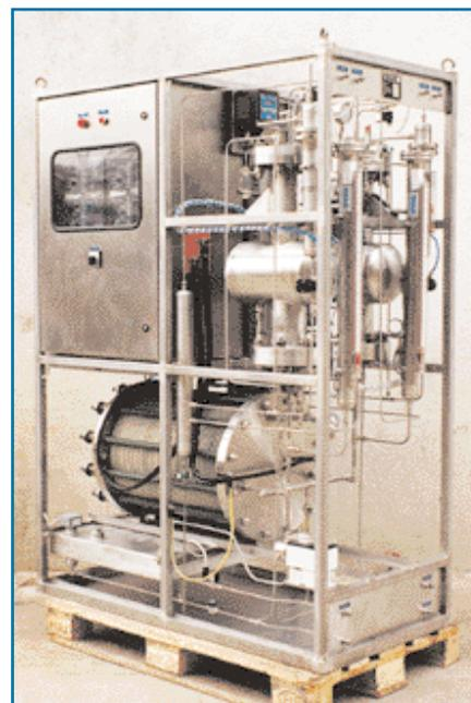
Unità di generazione di H<sub>2</sub> da fonte solare fotovoltaica
