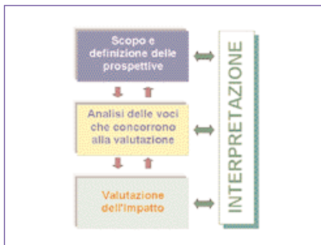
Figura 1 - Schema del Life Cycle Assessment secondo Iso 14040
