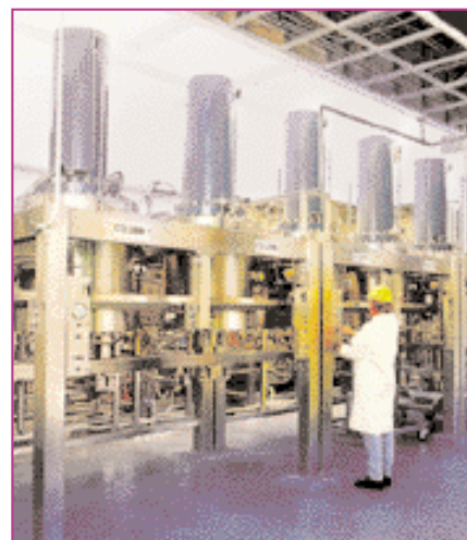
Impianto di cromatografia chirale Smb realizzato da Novasep
