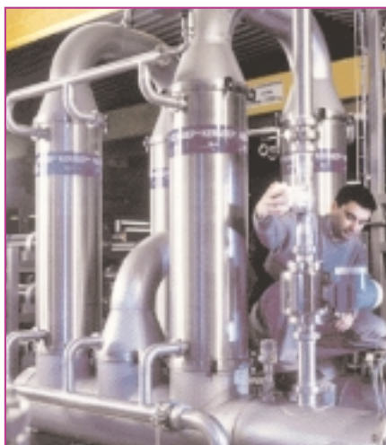
Kerasep, membrana minerale tubolare ceramica
