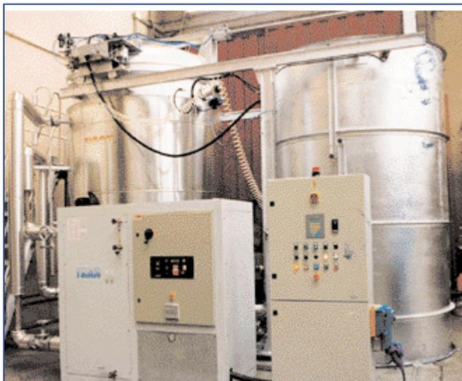
Impianto per l'imbibizione di olio isolante per trasformatori
