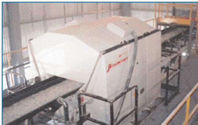
Un'apparecchiatura per l'analisi pronta con neutroni del cemento di costruzione Thermo Gamma-Metrics (San Diego, CA)
