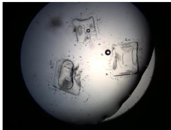
L'acqua entra in contatto con i cristalli e questi si riducono progressivamente
